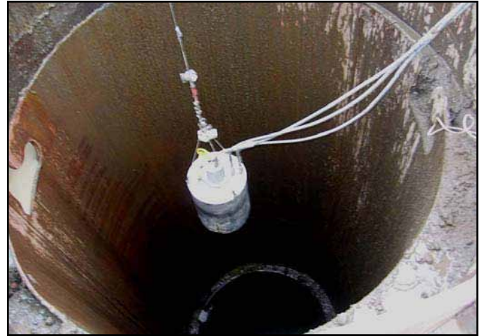
Figura 10: Dispositivo de inspección de fustes perforados
