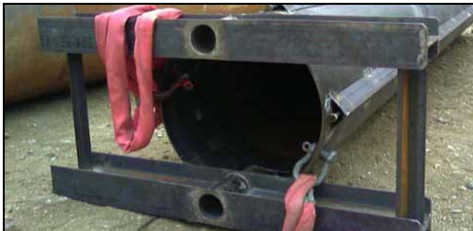
Figura 6: Plantilla para la instalación de columnas
